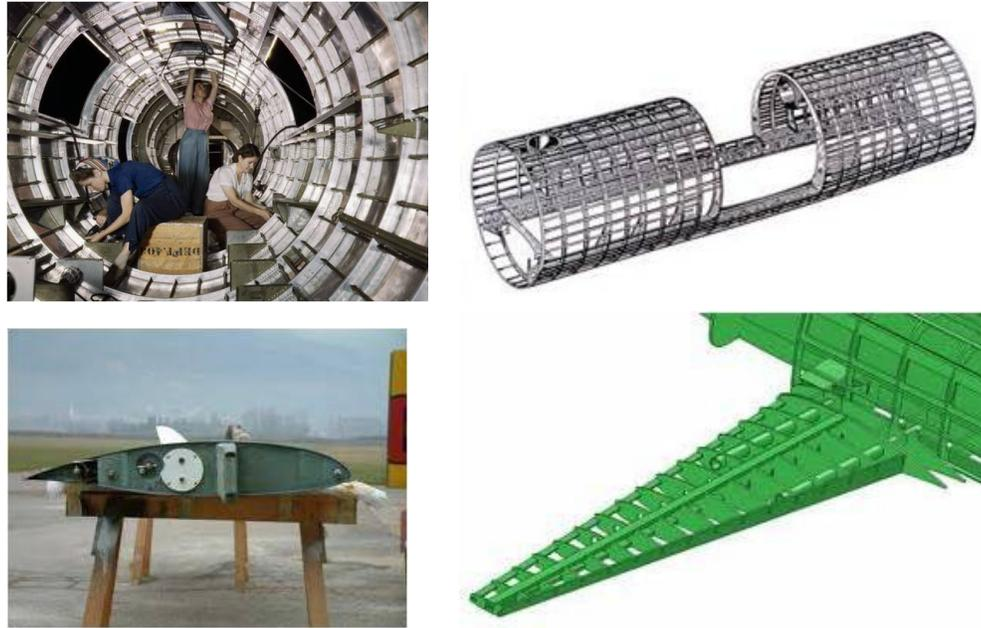
Figura 1: Configuración estructural de alas y fuselajes: larguerillos, costillas y recubrimiento
