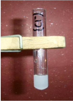
Fig 7. Confirmación de presencia de cloruros.
