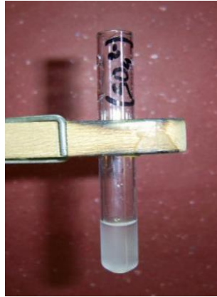
Fig.8.Confirmación de presencia de sulfatos.
