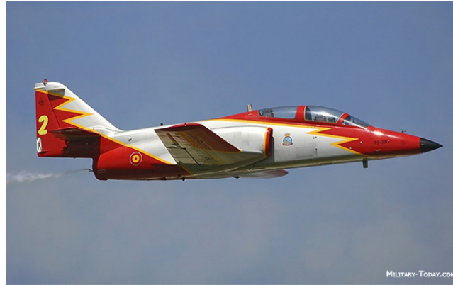
Figura 4 – Avión CASA-101 AVIOJET. Superficie alar, S_w = 20 \text{ m}^2 . Envergadura b = 10.6 \text{ m} . Peso W = 49 \text{ kN} .
