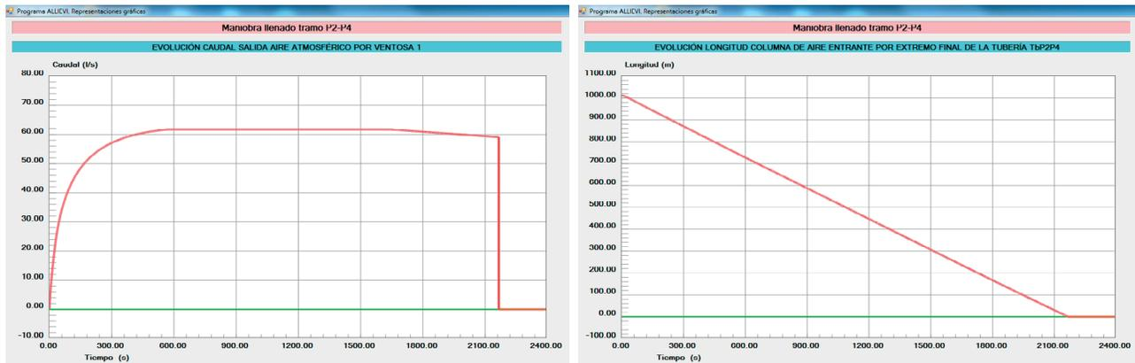
**Figura 13** | Llenado de la tubería entre las secciones P2 y P4. Evolución del caudal de aire expulsado por la ventosa (condiciones atmosféricas). Y evolución de la longitud de la columna de aire en el interior de la tubería de ensayo.
