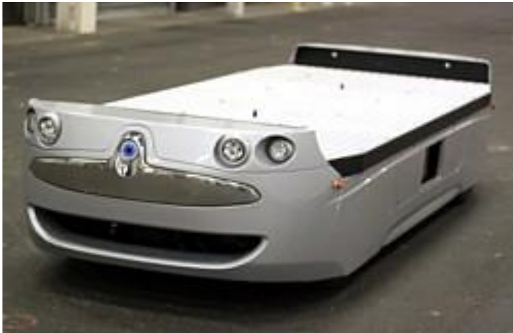
Sistema de transporte de carga FRT de Masdar City
