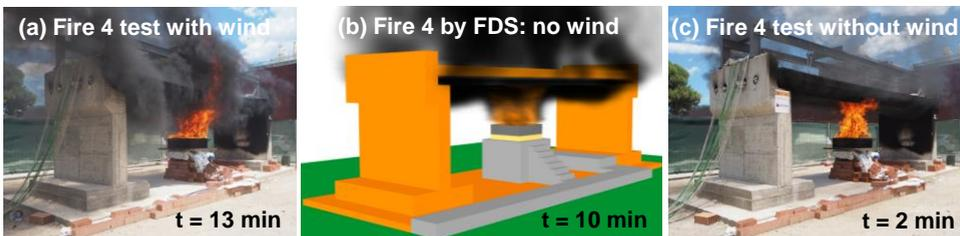
*Figura 11-4. Efecto del viento en el escenario de fuego Fire 4: (a) Ensayo Test 8 con viento, (b) Simulación numérica sin viento y (c) Ensayo Test 8 sin viento.*
