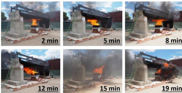
*Figura 6-13. Evolución del efecto del viento durante el ensayo Test 8.*
