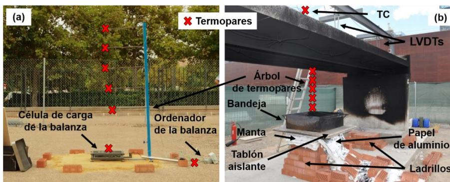
*Figura 4-6. (a) Báscula antes de incluir la protección para los Ensayos preliminares. (b) Protección de la báscula con manta aislante, tabloncillos aislantes, ladrillos y papel de aluminio.*
