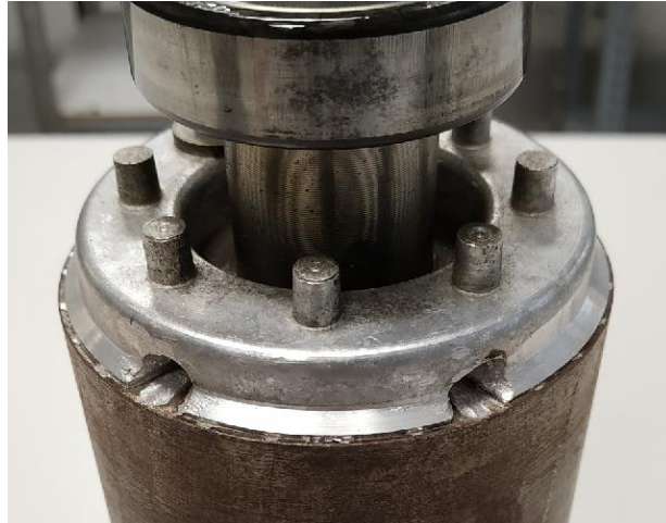
Fig. 27 Imagen de rotor con avería forzada. Rotura de dos barras no adyacentes
