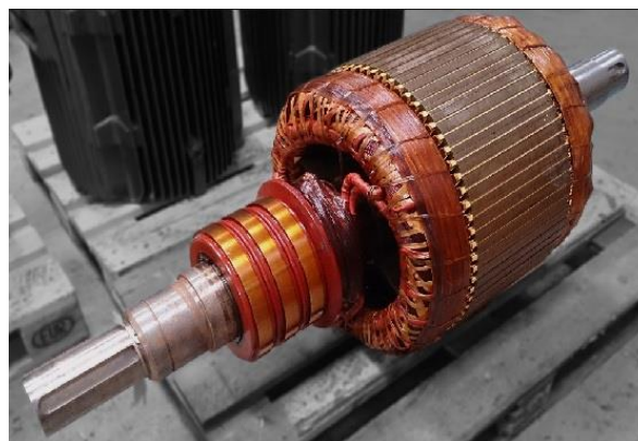
Fig. 3 Rotor bobinado (con anillos rozantes) [20]
