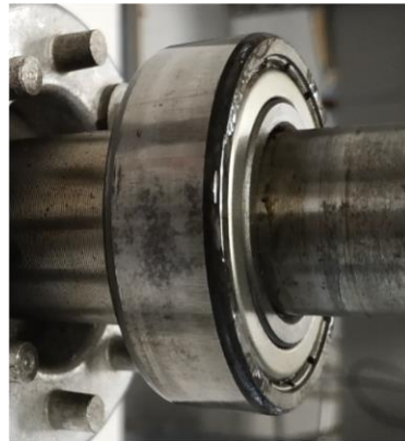
Fig. 5 Rodamiento de bolas con signos de desgaste externos
