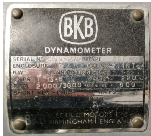
Fig. 28 Placa de características de la carga arrastrada
