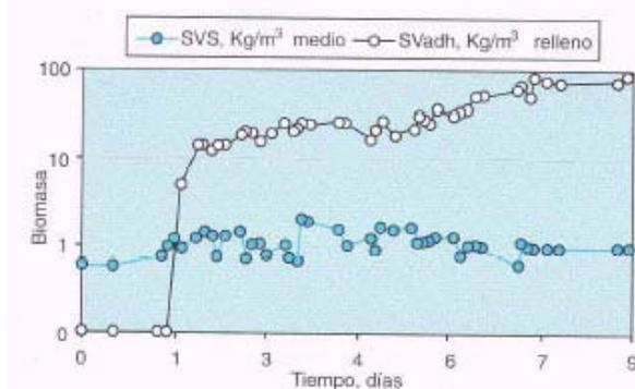
**Figura 2:** Representación, escala logarítmica, de la evolución en el contenido de sólidos volátiles en suspensión ( $\text{kgSVS}/\text{m}^3\text{medio}$ ) y sólidos adheridos al relleno ( $\text{kgSV}_{adh}/\text{m}^3\text{relleno}$ ) durante el proceso de colonización
