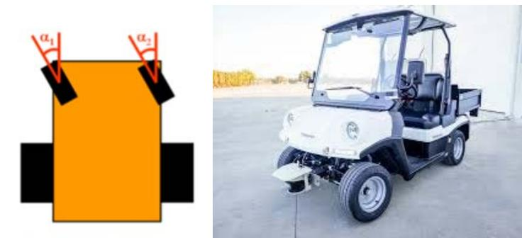
**Figura 2.19 Configuración Ackerman**
