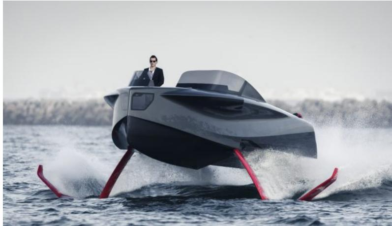
Figura 3: Ejemplo de hidróptero. De la página web de Motor Boat & Yatching
