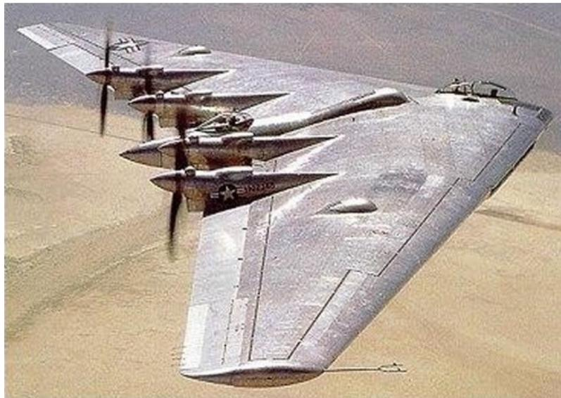
Figura 2: Northrop YB-35. Ejemplo de ala volante. De Wikipedia
