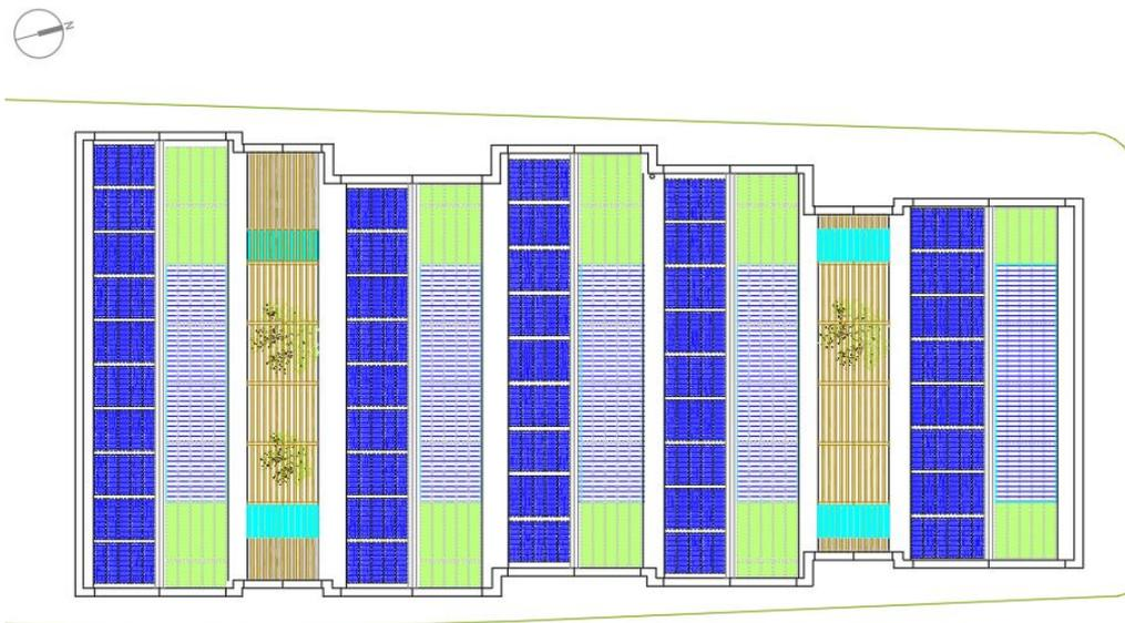
Imagen 63. Situación de la instalación fotovoltaica en las cubiertas del edificio. Fuente: Proyecto de ejecución
