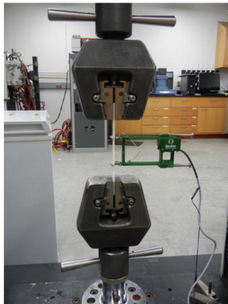
Fig. 1: Diseño de probeta de tracción y máquina de ensayo (extraído de Tymrak, Kreiger y Pearce 2014)
