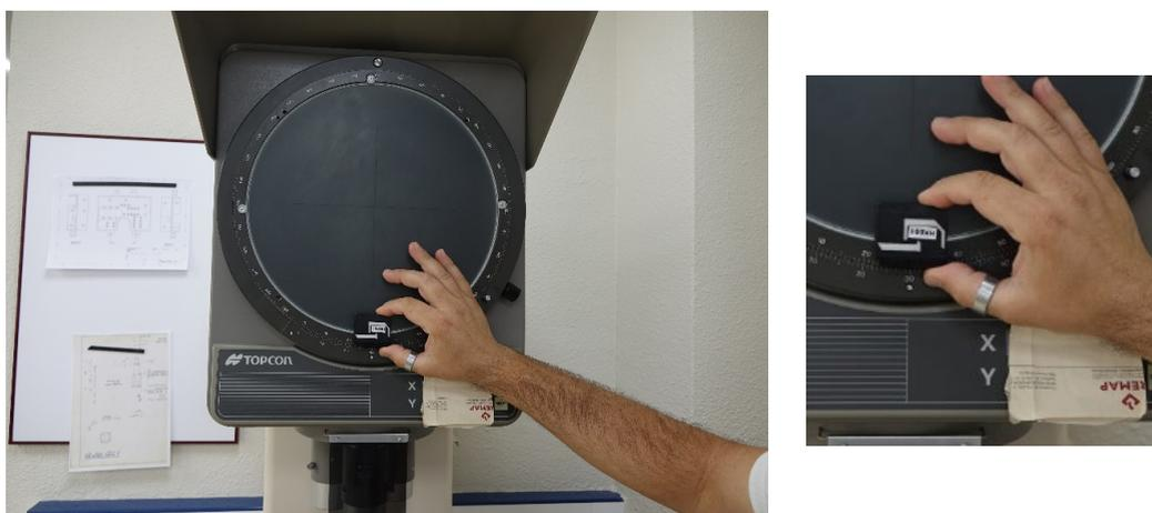
*Fig. 3. Medición en el proyector de perfiles en el laboratorio acreditado de FREMAP.
