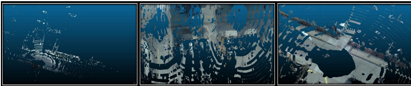
Figura 6: Diferentes vistas dentro de un mapa global texturizado y mallado. La discontinuidad del mallado se debe a la velocidad de adquisición de la plataforma.
