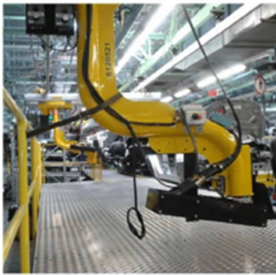
Ilustración 43. Instalación de un happy seat en un puesto de montaje 26 .
