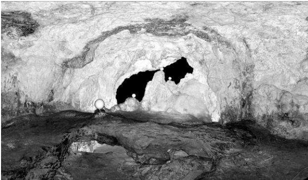
Figura 2. Imagen panorámica de la nube de datos láser de la galería orientada al oeste. Los círculos blancos se corresponden con esferas
