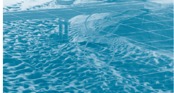
Figura 6.-Modelo físico a fondo móvil.
