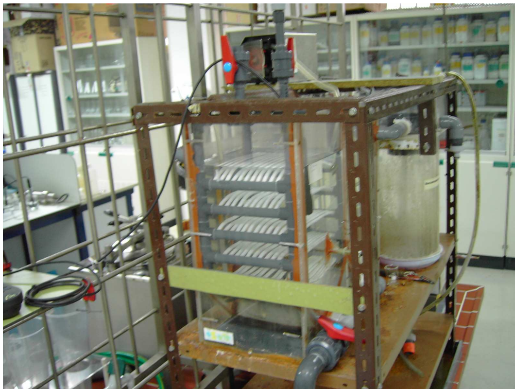
Figura 2. Imagen del reactor de membrana tubular a escala de laboratorio utilizado en los ensayos de aireación
