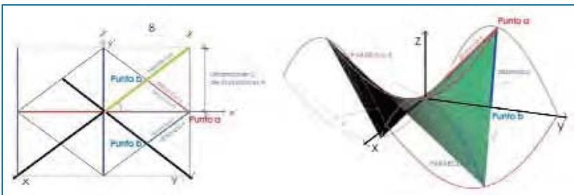
Fig. 6. Ubicación de puntos en la superficie de un paraboloides hiperbólico.
