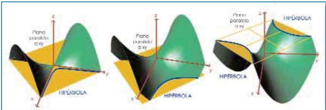
Fig. 3. Ubicación de hipérbolas en la superficie del paraboloide hiperbólico.
