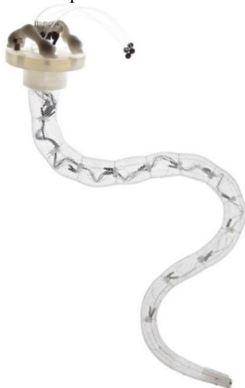
Figura 1: Robot hiper-redundante de tipo continuo y blando compuesto por una funda trenzada provista de aleaciones con memoria de forma (SMA) (Laschi and Cianchetti 2014).
