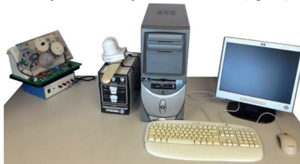
Figura 1: Sistema de planta con unidad mecánica 33-100 de Feedback.
