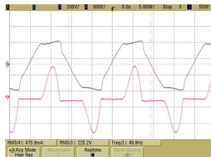
Figura 19. Voltaje de salida del inversor con carga no lineal, PI (superior, 200V/div) y corriente de salida del inversor con carga no lineal, PI (inferior, 500mA/div). Escala de tiempo = 5ms/div.  $THD_v = 9.4\%$ .
