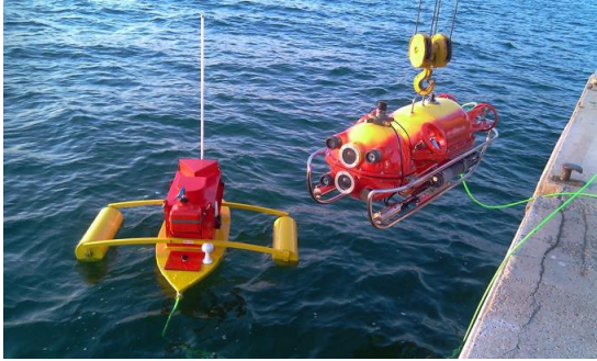
Figura 1. Plataforma submarina experimental no tripulada (AEGIR-UPCT): (a) Vehículo submarino autónomo; (b) Vehículo de superficie.
