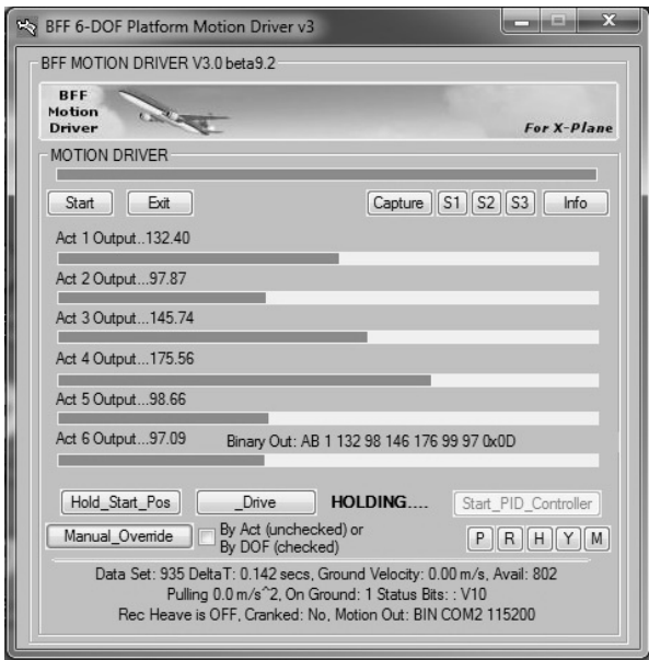
Figura 3: Captura de pantalla de BFF Motion Driver mostrando las posiciones de referencia para los diferentes actuadores.
