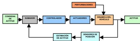
Figura 2: Diagrama de bloques de un AOCS
