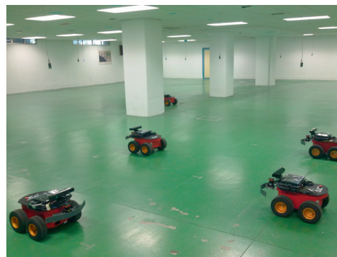
Figura 2: Fotografía del banco de pruebas instalado en una sala de 500 m 2 en los sótanos del edificio principal de la Escuela Técnica Superior de Ingeniería de la Universidad de Sevilla. Pueden observarse 5 robots Pioneer 3-AT y los nodos de la red WSN colgando del techo.
