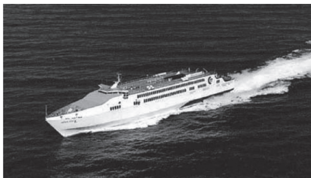
Figura 7: Silvia Ana, ferry rápido de 110 m de eslora y velocidad de 40 nudos.
