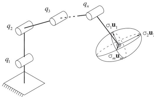
Figura 1: Elipsoide de Velocidad.
