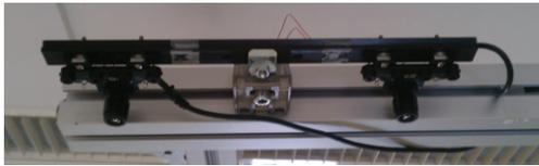
Figura 5: Imagen real del sistema de estereovisión de bajo coste.
