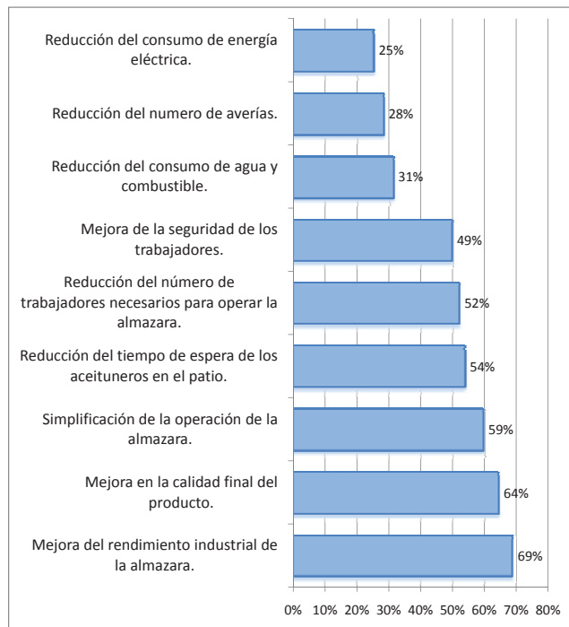
Figura 15: Ventajas de la automatización del proceso de elaboración de aceite de oliva virgen.
