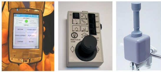
Figura 4. Interfase de control del ASIBOT basada en PDA y varias adaptaciones.
