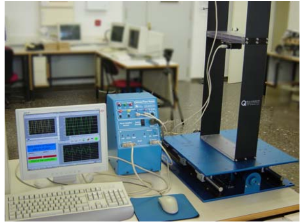
Fig. 13: Prototipo Shaker II, de Quanser Consulting
