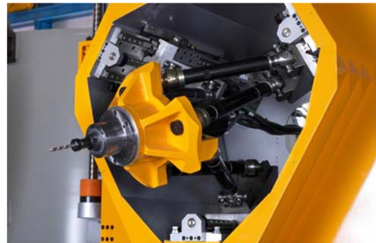
Figura 1. Cabezal de cinemática paralela Hermes (Cortesía de MTorres y Fatronik).
