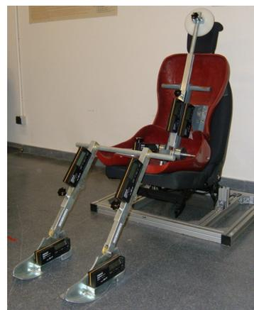
Figura 13. Maniquí utilizado en la aplicación de control de fuerza.
