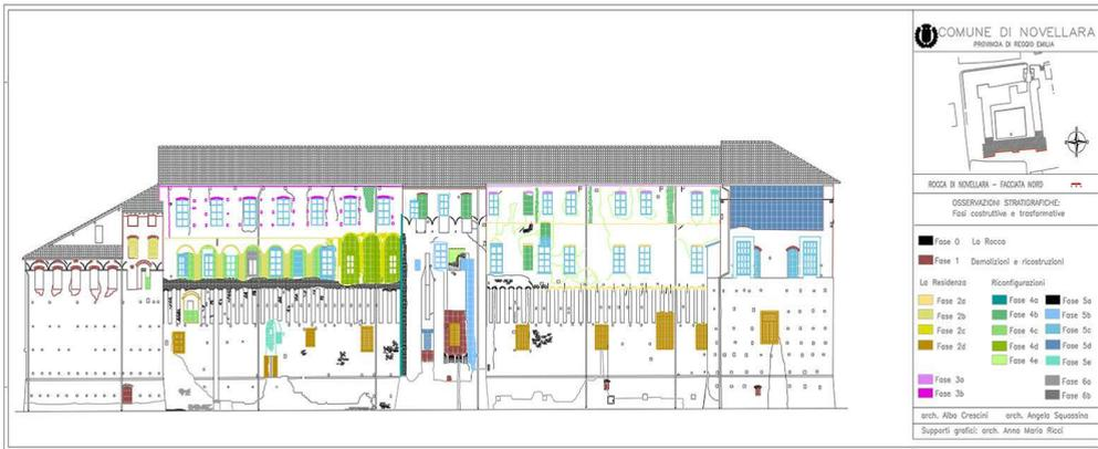
Fig. 9. Schema riepilogativo delle diverse fasi costruttive individuate (A. Squassina, A.Crescini).
