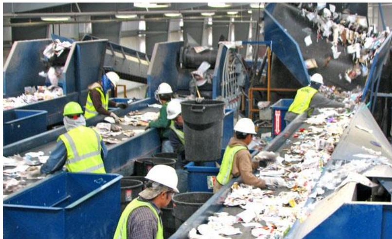
*Ilustración 4. Cinta de clasificación manual de residuos.*
