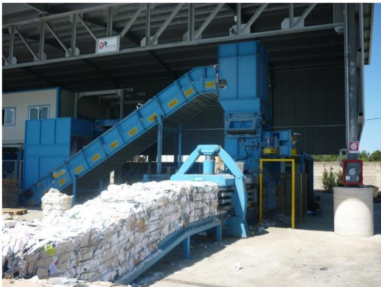
*Ilustración 3. Prensa fabricada para residuos.*
