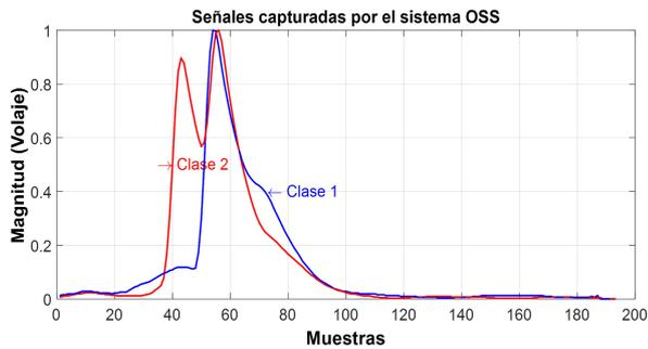
Figura 1: Señales captadas por el sistema OSS tanto para una fuente (señal Clase 1) como dos fuentes de radiación (señal Clase 2).
