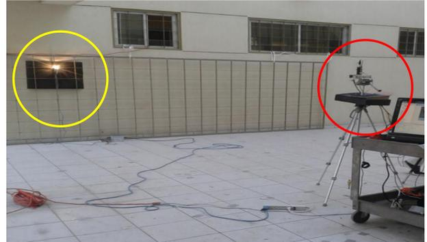
Figura 2: Fuente de referencia (circulo amarillo) montada en una estructura y el sistema óptico de barrido (circulo en rojo).
