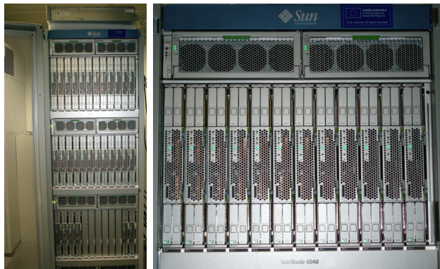
Figura 4.32: Cluster de computación de 30 blade servers (ITI).
