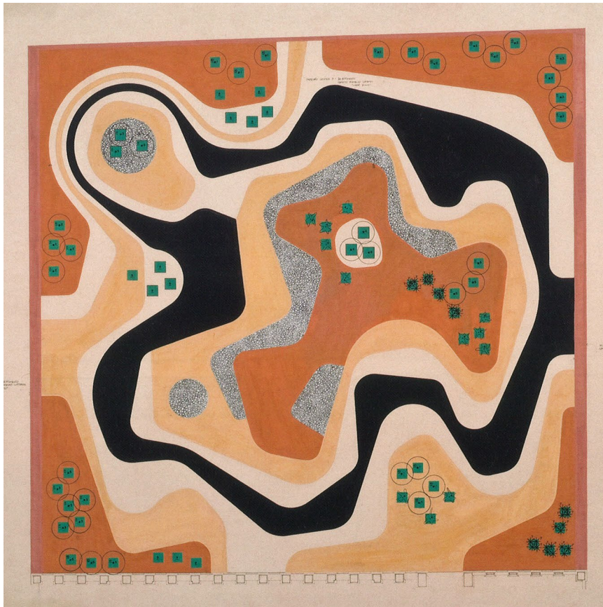
R. Burle Marx. Pavimento exterior construido con caliza blanca y roja, basalto negro, canto rodado y arcilla expandida. Cubierta jardín del Banco Safra Park, Sao Paulo, 1983-1986.
