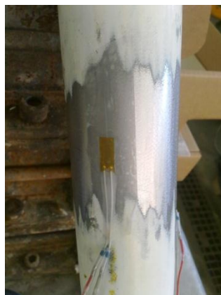
Fig. 3.6 Galga pegada en la superficie del puntal
