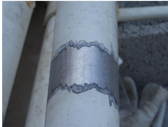
Fig. 3.5 Superficie del puntal una vez pulido
