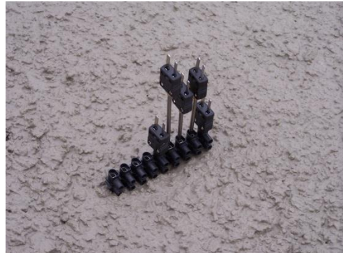
Fig. 3.53. Termopares embebidos en el hormigón en la zona del ábaco (forjado reticular de casetón perdido).
