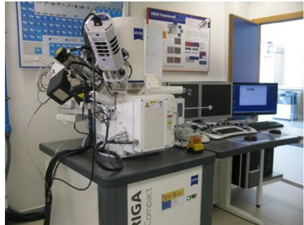
Figura 3. Microscopio electrónico de barrido FESEM-EDX con sistema FIB.
