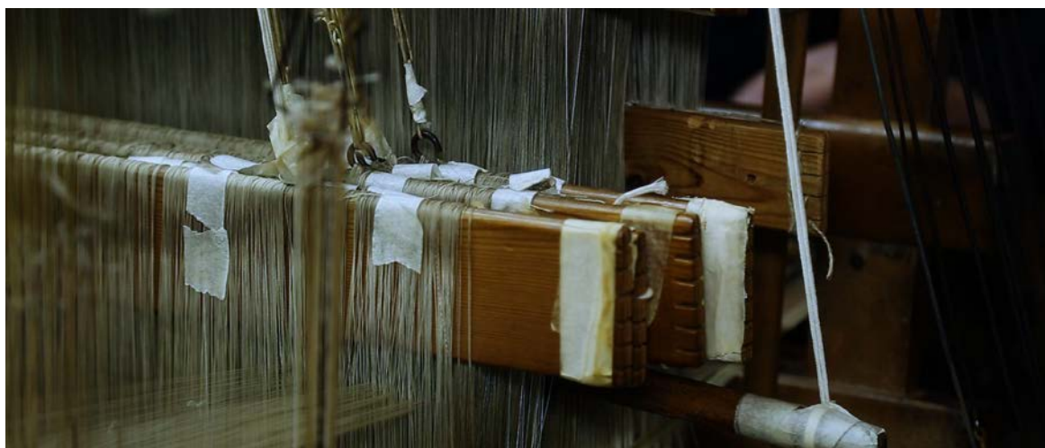
Fig. 2 Lizos de un telar Jacquard. Fábrica Garín 1820
