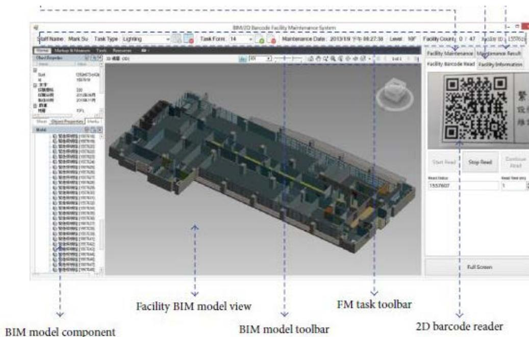
Ilustración 12 - Acceso a BIM mediante QR. Fuente: Lin et al. (2014).
