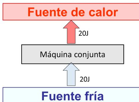
Figura 5: flujos netos de energía que la máquina conjunta intercambia con las fuentes de calor, para  $e_I > e_R$ .
