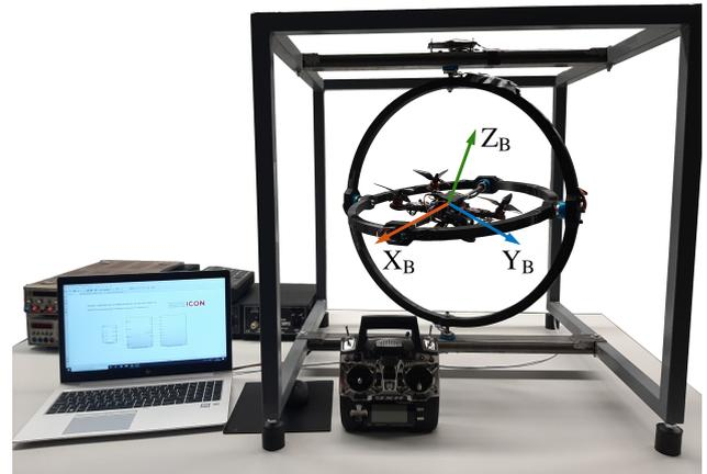
Figura 1: Plataforma para el control de la orientación de un multirrotor.
