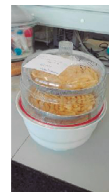
Imagen 6. Cámara de humedad relativa controlada para el estudio de almacenamiento y estabilidad. Fuente. Elaboración propia.
