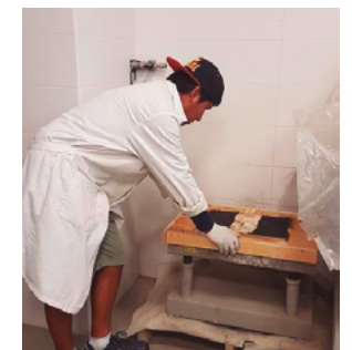
Imagen 4. Fabricación de la resilla en el momento del vibrado. Fuente. Elaboración propia.
