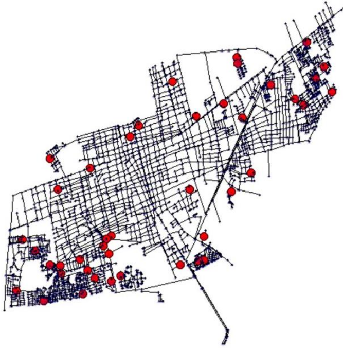
Figura 5.5. Ubicación de 41 sensores en la RDA de Coro según el valor de pagerank de los nodos.
