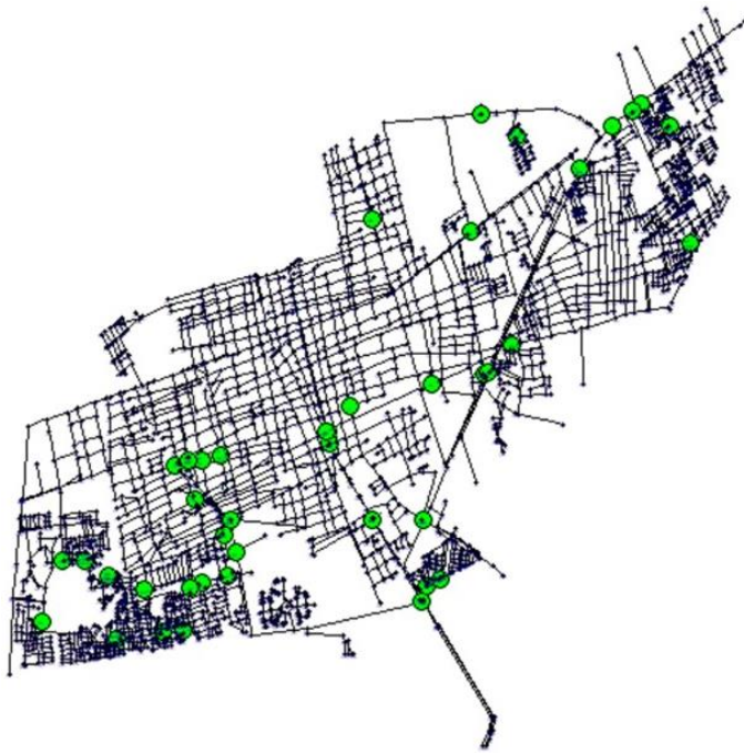
Figura 5.6. Ubicación de 41 sensores en la RDA de Coro según el valor de intermediación de los nodos.
