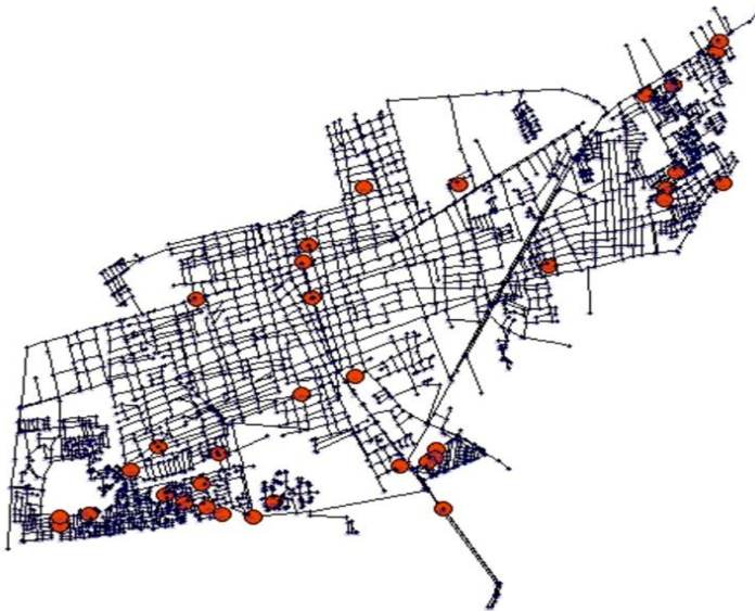
Figura 5.21. Red de Coro con los sensores correspondientes a la solución elegida
