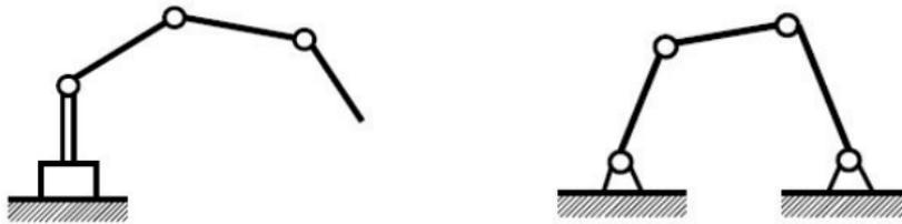
Figura 2.2: Robot serie (izquierda), robot paralelo (derecha)
