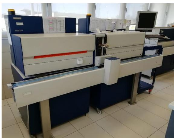
*Figura 11. MilkoScan FT6000 (FOSS) combinado con Fossomatic TF5000 (FOSS) en el laboratorio LICOVAL (UPV)*
