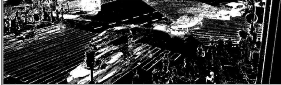
Fig.139: Imagen con fondo sustraído por método MOG2.
