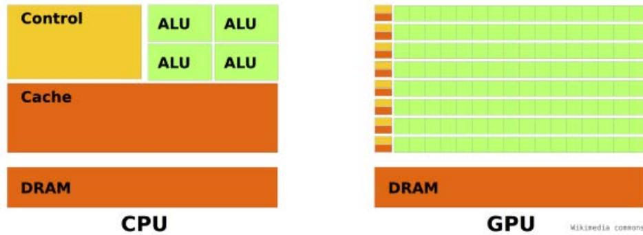
Fig. 3: Organización de módulos operativos de CPU vs. GPU.
