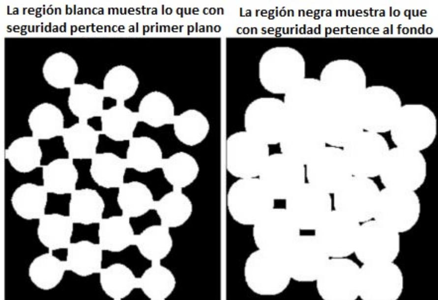
Fig.118: Procedimiento de segmentación por método de Watershed.
