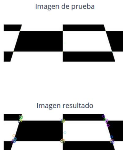
Fig.130: Ejemplo de aplicación del algoritmo FAST.
