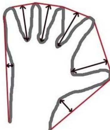
Fig.75: Ejemplo de envoltura convexa.
